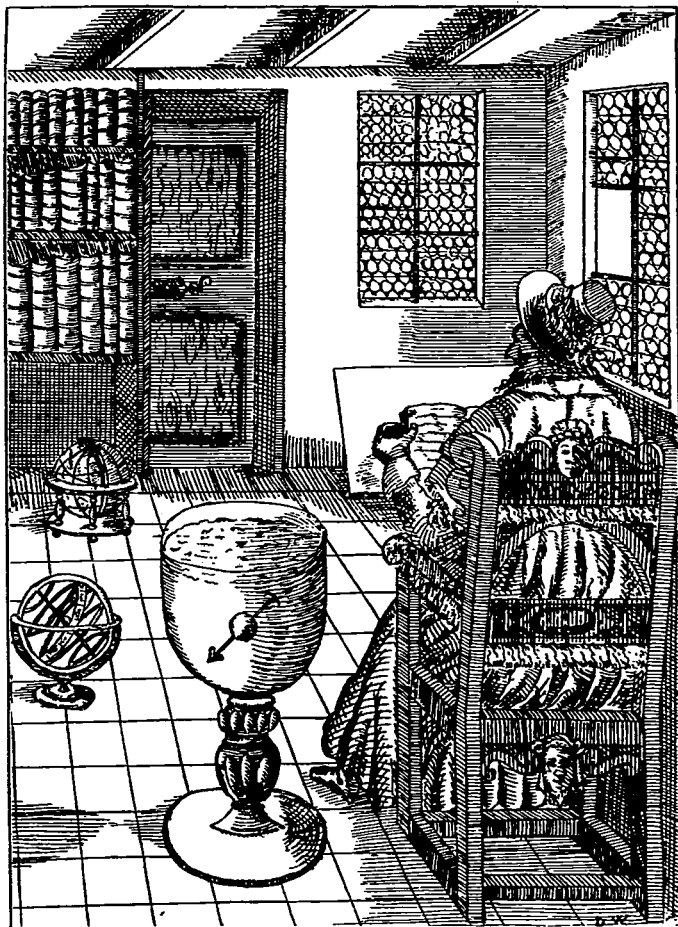
Стрѣлка наклоненій, укрѣпленная въ деревянномъ нарѣ и свободно плавающая въ водѣ (изъ книги Гильберта „De Magnete“).
