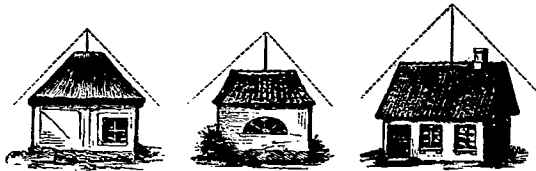
Форма крыши и высота громоотвода.
